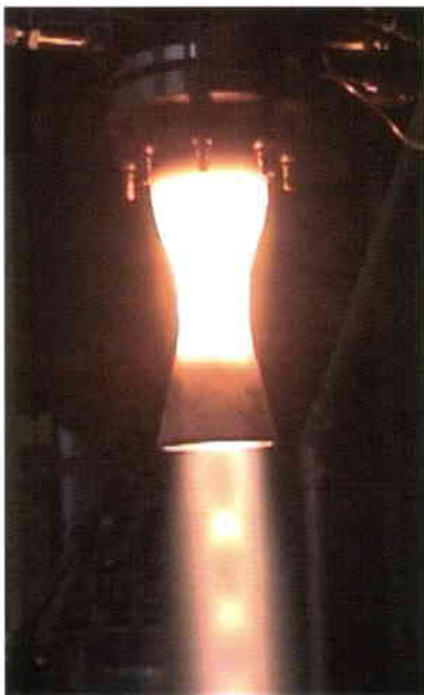
EADS ST (D) - Liquid Apogee Motor undergoing sea level testing
